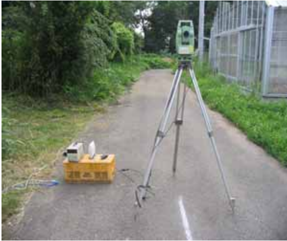
図3 トータルステーションと無線LAN装置
