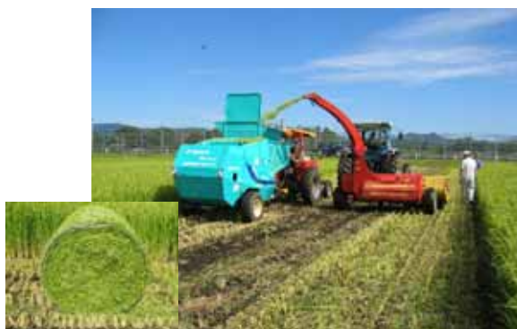
図4 フォレージハーベスタと細断型ロールベアラの伴走による拾上げ・細断・梱包作業
