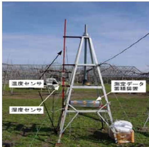
図1 果樹園内の高さ別気温の測定
