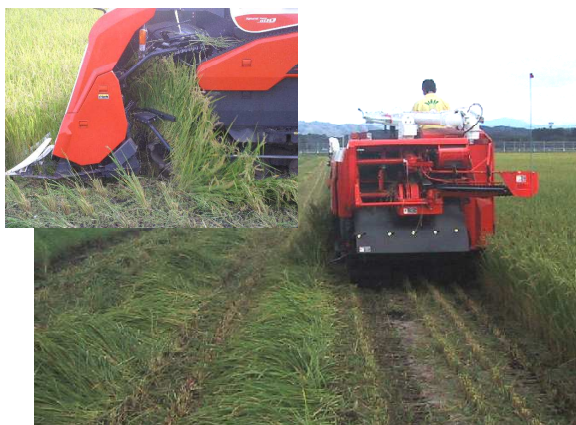
図3 自脱コンバインによる刈り倒し作業
