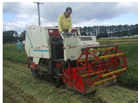
図4 自走式ベアラ(一部改造)による梱包作業
