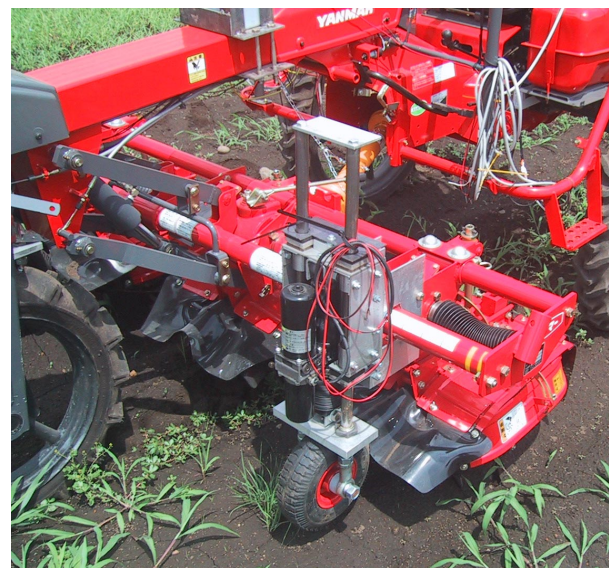
図5 ゲージホイール位置制御装置を付加したロータリカルチベータ
