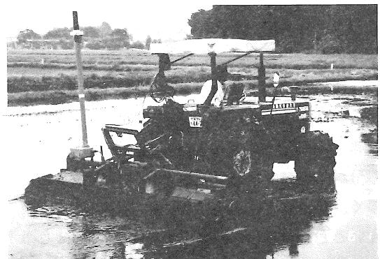
図4 自動高低制御の代かき作業
