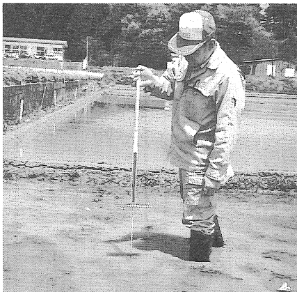
写真1 代かき土深さの測定風景
