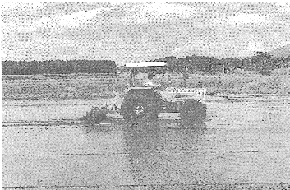
写真2 乗用型左右揺動式床締め代かき機の作業風景
