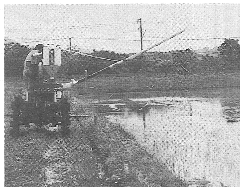
図6 流し多口噴頭固定方式による作業
