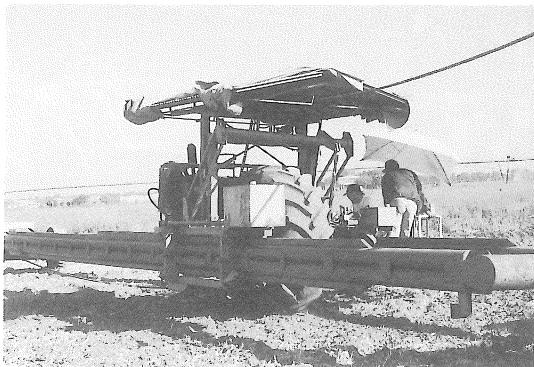
図1 可動式単車輪性能試験機
