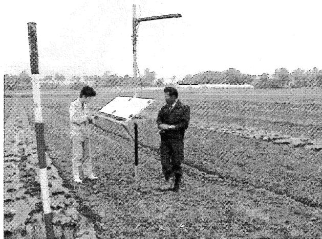
図2 圃場の無線LANとネットワークカメラ（電源は太陽電池を利用）
