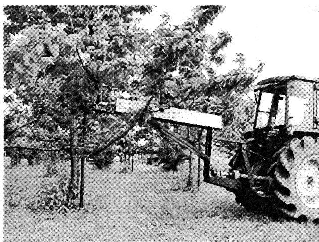
図1 試作トラクタ用シェーカ
