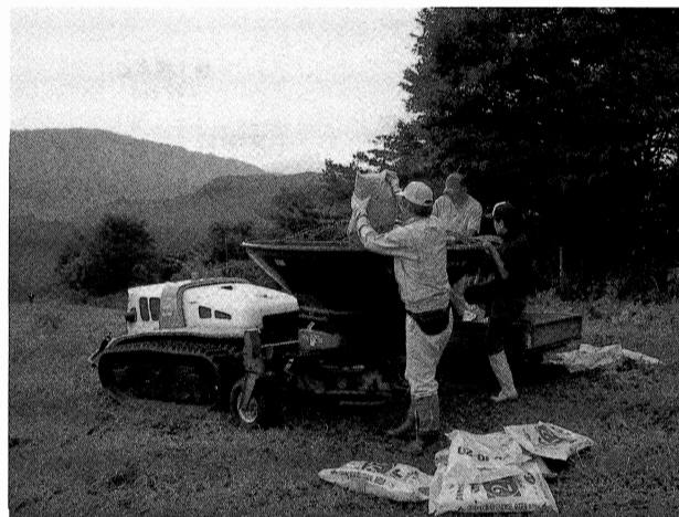
図6 無線草刈機に取り付けたブロードキャストに対する肥料の投入状況
