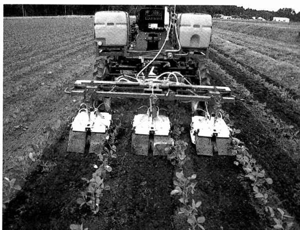
図3 試作機によるハイブリッド除草作業 (電動ポンプ加圧方式)
