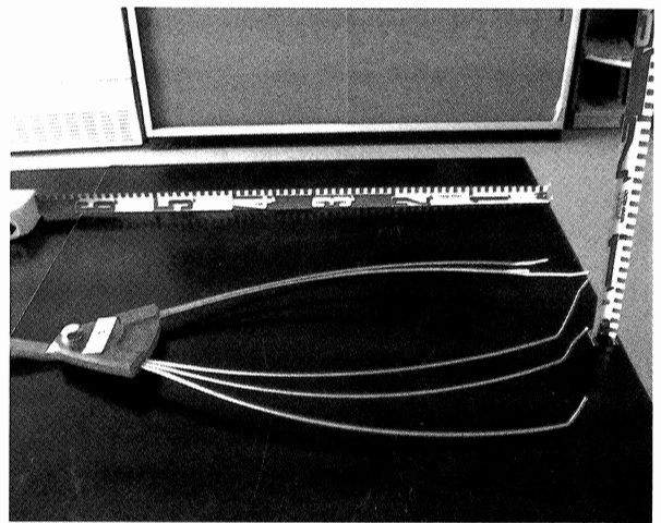
写真1 Hレーキ(針金内中側の直径3.0mm、外側4.5mm)
