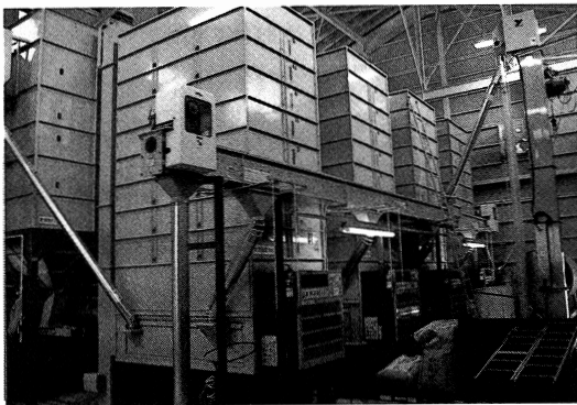
図8 RCでの遠赤外線乾燥機の導入
