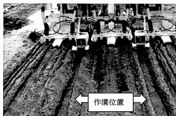
図6 従来機（溝切器MPV60）による作溝作業の状態
