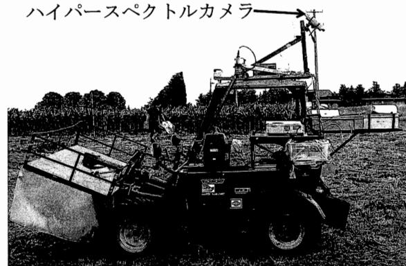
図 2 車載型撮影システム
