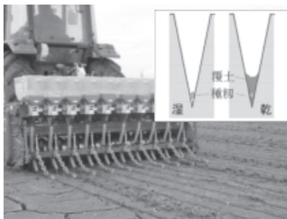
図1 不耕起V溝直播機と播種溝模式図
