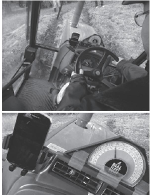
写真1 転倒通報実証試験のスマートフォン取り付け状況
