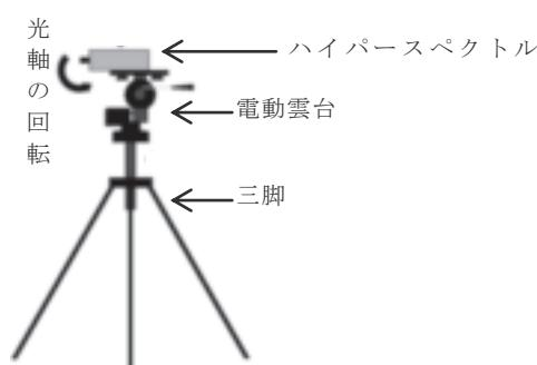
図 2 携行型センシングシステムの模式図
