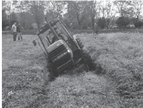
写真2 転倒通報実証試験 (福島県農業総合センター農業短期大学校研修部・転倒体験施設 最大斜度35°)
