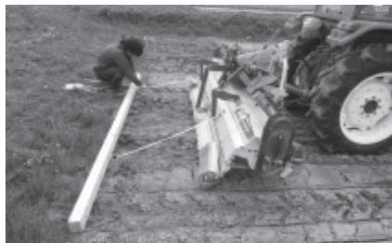
図3 代かき、角材のトラクタ取付状況（T PW区）
