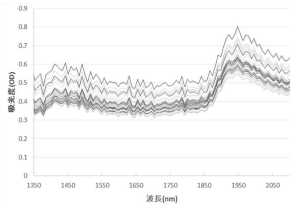
図5 MicroNIR2200による塩害供試体のスペクトル(1353-2150nm)
