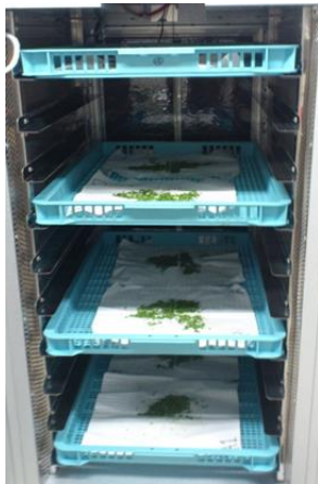
図1 遠赤外線乾燥の様子（棚位置の違いが乾燥特性に及ぼす影響）
