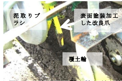
図5 改良爪2, 覆土輪などを装着したポット苗田植え機の植付部の状態
