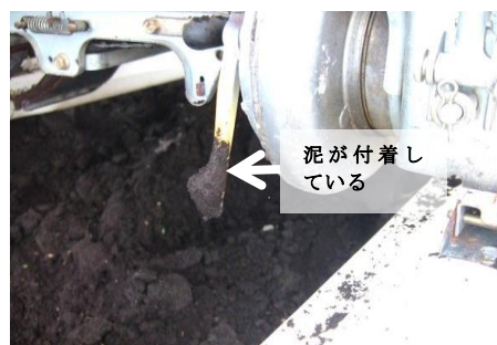
図1 ポット苗田植え機の出荷時設定での畑圃場への移植により移植爪に泥が付着した状態
