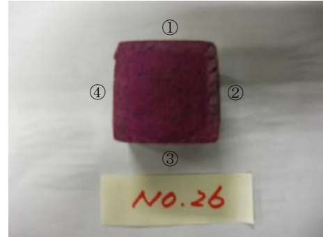
図3 フェノールフタレイン法による中性化深さの測定
