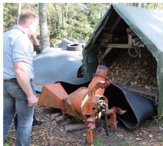
写真3 トラクタ直装のチップパによる木質チップの自給
