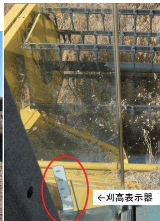
写真6 SAMPO 製コンバイン (左：Favabean 収穫，右：刈高表示器)
