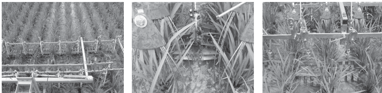
図2 けん引式水田用除草機による除草の状況 (左 田植機上から撮影, 中央 米輪+レーキ, 右 水田輪)
