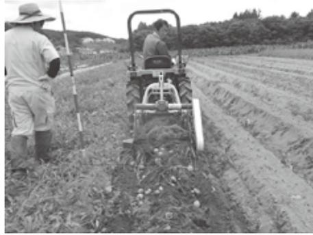
写真11 バレイショ 収穫（コンベア式掘取機）
