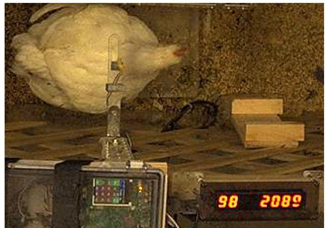
図4 RFID 受信対応体重計と7セグLEDによる ID (98 番) と鶏体重 (2089g) の表示状況
