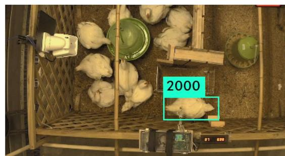
図9 体重計の表示とAIによる鶏の体重推定 (RFID: No. 97)
