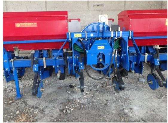
図2 Moldagrotehnica 社製の不耕起播種機
