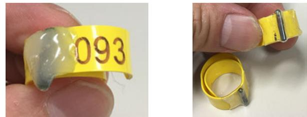
図 6 鶏脚帯への RFID の取付け状況（左：ホットメルト接着剤、右：透明熱収縮チューブによる接着）
