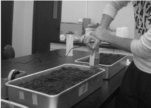
図 1 室内試験における土壌圧縮の様子
