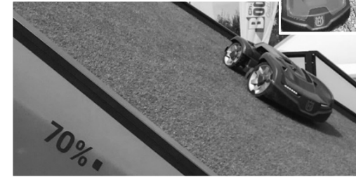
左上: 4 輪駆動で後部に刈刃がある, 右上: 装置についての質疑応答, 下: 斜面(70% ≒ 35°)での実演 写真 5 AUTOMOWER435AWD (Husqvarna 社) の実演展示
