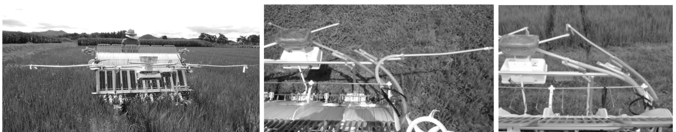
図2 試作した追肥用施肥機 (左: 追肥作業 中: 吐出パイプを展開した状態 右: 走行時の吐出パイプを折りたたんだ状態)
