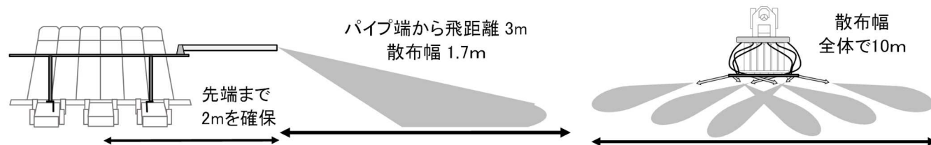
図1 側条施肥田植機を利用した追肥用施肥機の模式図 (左:後ろ側, 右:上側から見た状態)
