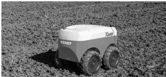
写真 3 MARS プロジェクトでの自律作業播種機 (XAVER, Fendt 社, 2017)
