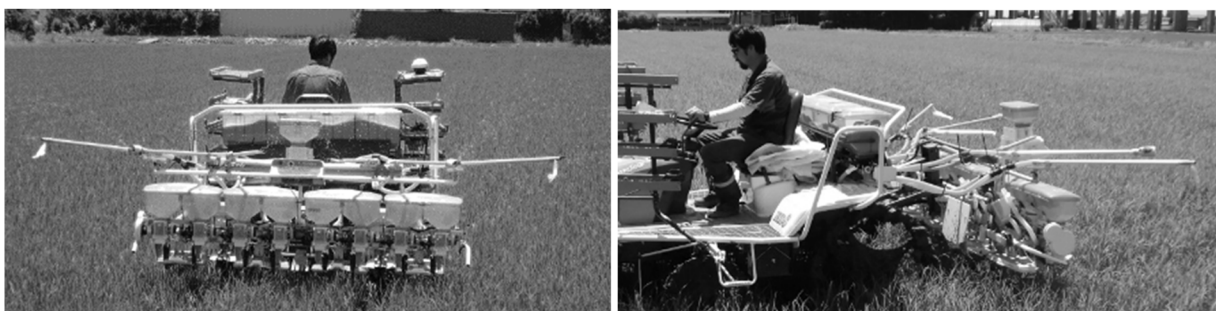
図4 鉄コーティング直播機を利用した追肥用施肥機 (左：後ろ側, 右：横側から見た施肥部)
