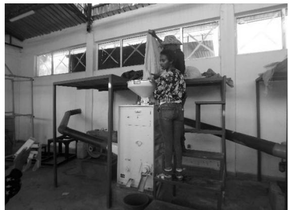
図6 サタケ式籾摺り精米機 (NRRTC 所蔵)
