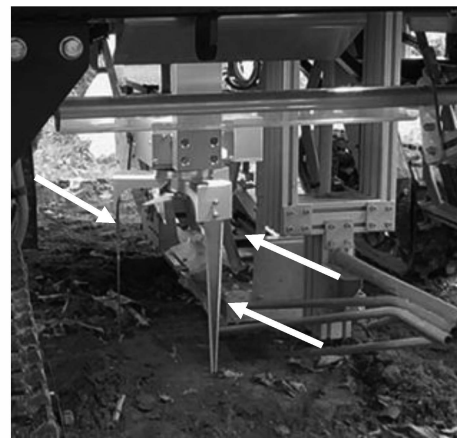
図5 横方向から見た外葉カットユニット 注:矢印部が外葉カットの刃
